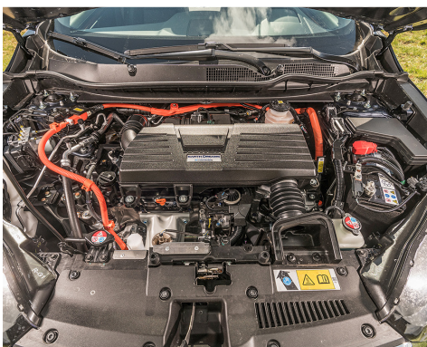
Il motore a benzina produce elettricità.
