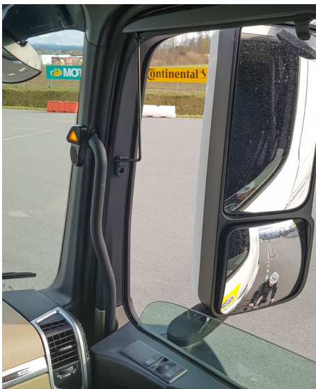
Una spia luminosa avverte della presenza di un ciclista nell'angolo morto del camion.
