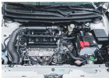
Le bloc 1,2 l essence est couplé à un alternodémarrreur donnant plus de tonus aux reprises.
