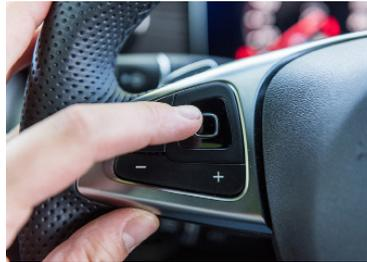
Les mini pavés tactiles commandent l'instrumentation de manière verticale et horizontale.
