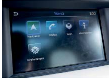
Ecran 7 pouces Il abrite diverses applis. Commande tactile ou via une molette.
