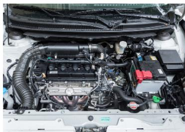
Il benzina 1,2 l riceve appoggio dal motore elettrico in fase d'avvio e d'accelerazione.
