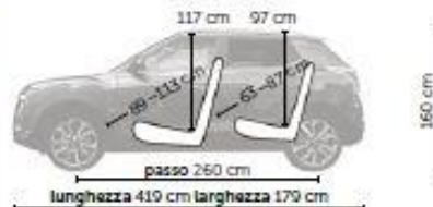
larghezza interna: ant. 147 cm, post. 146 cm bagagliaio: 423-1115 litri pneumatici: 215/45R18, min. 205/60R16
