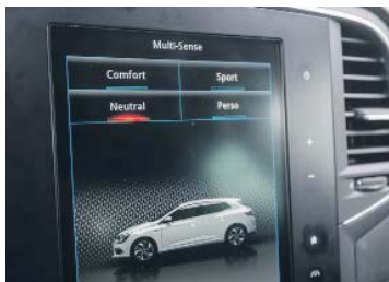
4 modalità Modificano la reattività del motore e dello sterzo, ma non la taratura del telaio.
