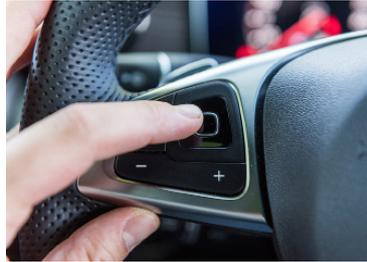
Mini touchpad comandano la strumentazione in senso verticale e orizzontale.
