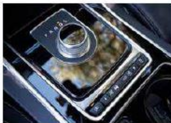
Comando del cambio Una pratica rotella con 4 parametraggi a scelta.
