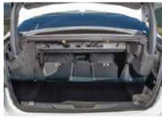
Bagagliaio da berlina Due ganci permettono di abbassare i 3 elementi della panca posteriore.
