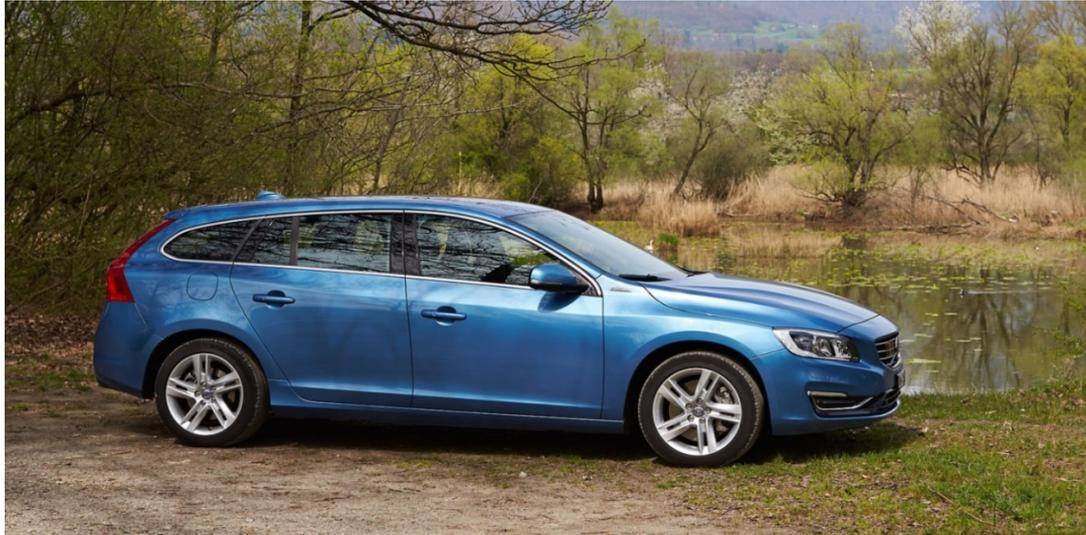
DER LANGSTRECKENTAUGLICHE VOLVO V60 D6 PLUG-IN HYBRID ÜBERZEUGT BEI DEN HAUPTKRITERIEN SICHERHEIT, DESIGN, AUSSTATTUNG UND ÖKOLOGIE, STELLT ABER EIN PAAR FRAGEZEICHEN BEI DEN KOSTEN UND DEM HOHEN GEWICHT VON ÜBER 2 TONNEN. GENERELL ARBEITET DAS 2.4L DIESEL AGGREGAT SEHR HARMONISCH MIT DEM AUF DIE HINTERACHSE WIRKENDEN ELEKTROMOTOR ZUSAMMEN UND ERMÖGLICHT BEACHTLICHE FAHRLEISTUNGEN.
