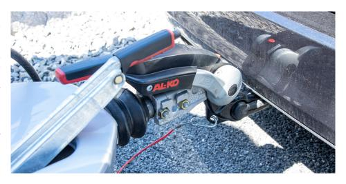
abfällt bzw. ausklinkt und sich mitsamt Anhänger "verabschiedet" wird als kaum existent beurteilt. Das Anbringen einer verschraubten Befestigungslasche oder eines Stahlrings mit 50 mm Innendurchmesser am abnehmbaren Teil der AHK ist bei dieser Interpretation zulässig.
