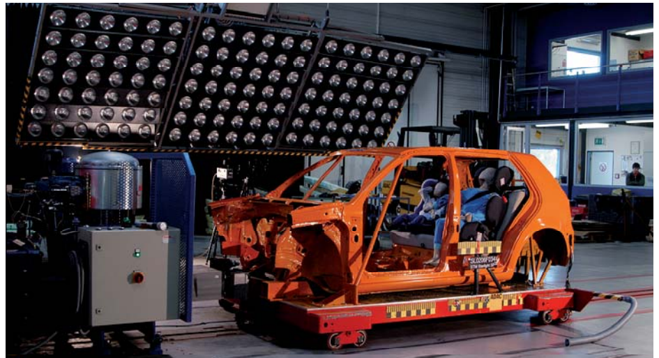
I seggiolini per bambini testati subiscono annualmente più di 100 collisioni frontali e laterali.
