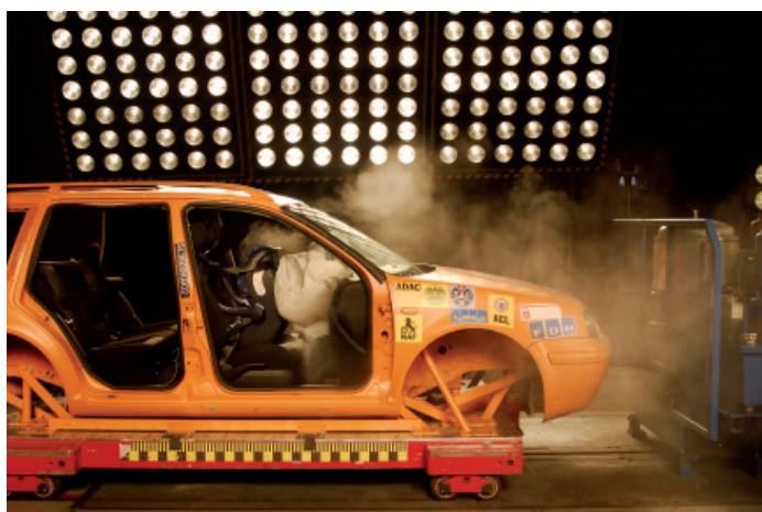
Navicella per neonato sul sedile passeggero anteriore: pericolo mortale in caso di attivazione dell'airbag.
