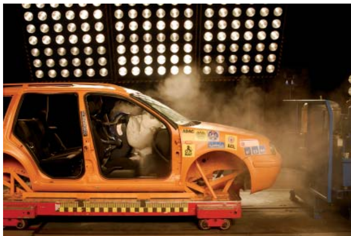
Coque pour bébé sur le siège passager: danger mortel lors du déploiement de l'airbag.
