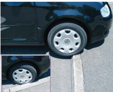
Kleines Bild: so entstehen Beschädigungen. Grosses Bild: korrektes Randsteinfahren.
