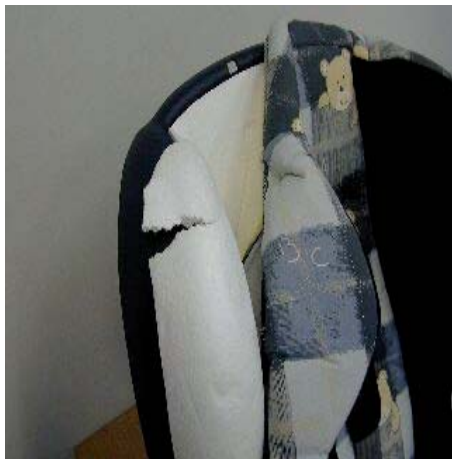
Bruch der Innenschale eines Kindersitzes (Bezug entfernt).
