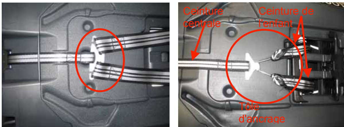
Système de ceintures du Michelin Cockpit avant (à gauche) et après l'essai (à droite)
