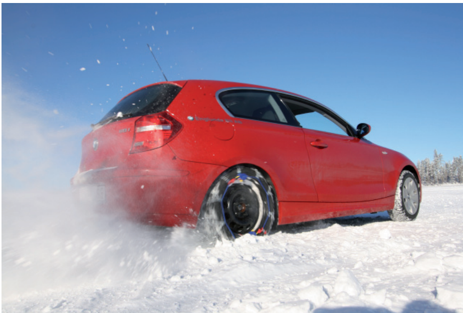
Catene da neve nuove si montano più facilmente. Allenate il montaggio però prima in un posto asciutto.
