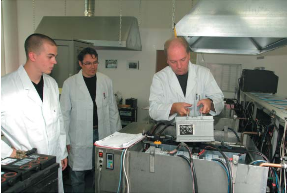
Die Batterie wird ins Wasserbad gestellt.
