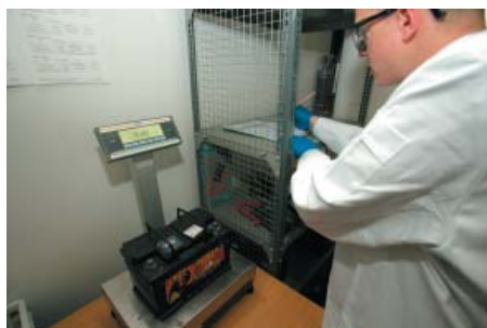
Wasserverbrauch: Wägung auf der Präzisionswaage.
