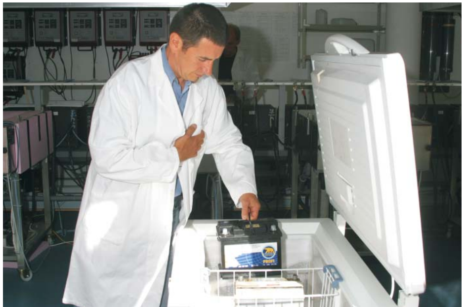
Die Batterie muss in die Tiefkühltruhe.
