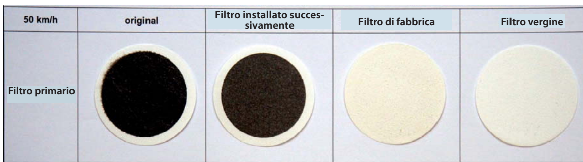
I filtri cartacei utilizzati per le misurazioni e intrisi di particolato mostrano con particolare chiarezza la diversa efficacia di filtri originali e di filtri installati successivamente.
