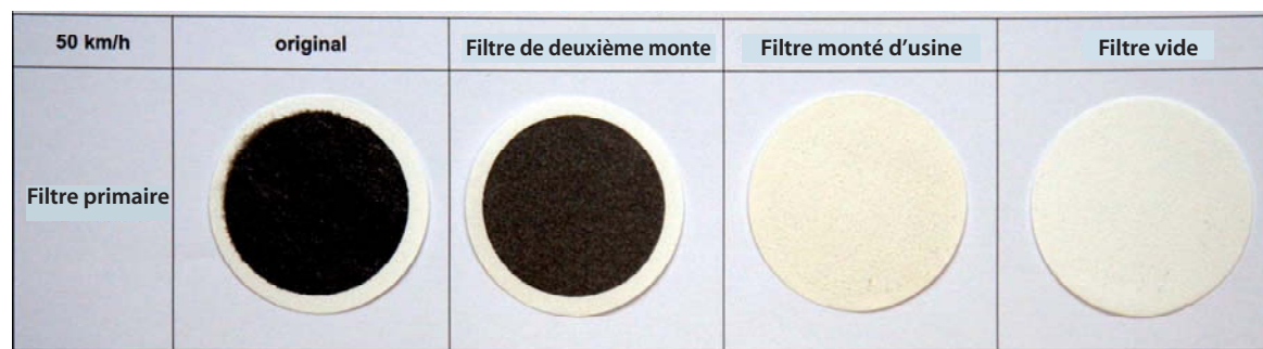
Les filtres en papier utilisés pour la mesure et recouverts de particules montrent nettement la différence d'efficacité des filtres à particules de deuxième monte et ceux d'origine.
