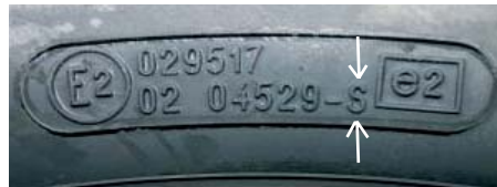
«S» = sound est inscrit sur le flanc du pneu.
