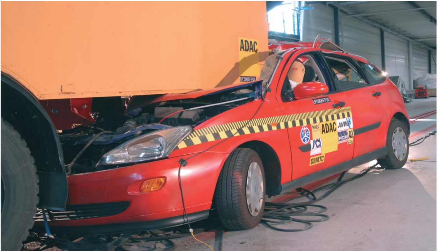
Unterfahrerschutz bricht. Auto fährt unter den LW
