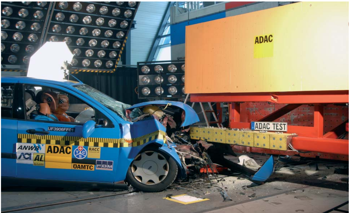
Unterfahrschutz hält. Autoinsassen werden geschützt
